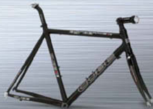
CUBE Agree Black Line RAHMEN Alu 7005 triple butted; ca. 1470 g** | GABEL Deda Black Blade | STEUERSATZ Ritchey Pro Integrated | VORBAU Deda Magic | SATTELSTÜTZE Scape Lite | RAHMENHÖHEN 50/53/56/58/60/62/64
