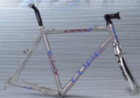
CUBE X-Race RAHMEN Alu 7005 triple butted; ca. 1560 g** | GABEL Scape Carbon | STEUERSATZ Ritchey Pro Integrated | VORBAU Deda Magic | SATTELSTÜTZE Scape Lite | RAHMENHÖHEN S/M/L/XL Sloping
