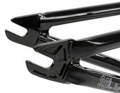
Cube Punisher Rahmen 4130 CRMO double butted Rahmen, Mid BB Tretlager, Semi integrated Headset, ausgefräste Ausfallenden, U-Brake Mounts, 3,2 kg, Farbe: schwarz, apple green, olive
